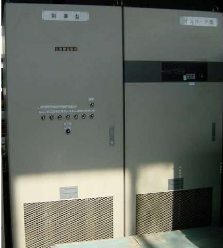
図 4.9 不平衡補償单相き電模擬装置外観
