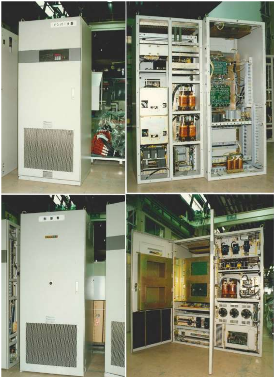
図 3.12 RPC ミニモデル (左上: インバータ盤, 左下: 制御盤, 右上下: 内部)
