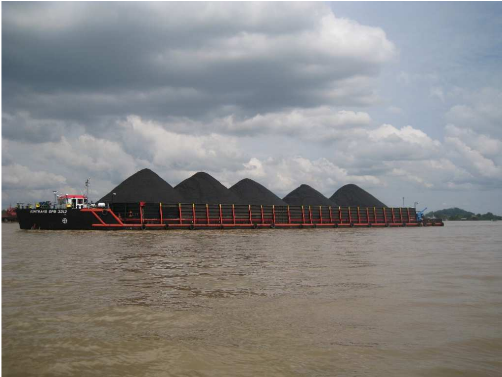
図 2.8 インドネシアの大河で石炭を山積みして上流から海へ運搬するバージ(1)
