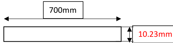
図 4.21 甲板および底板の等価板厚
