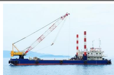
図-2.2.2 起重機船 (第78栄進)
