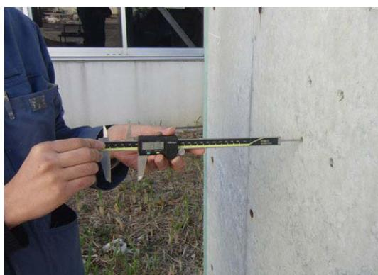
写真 2.3 ノギスによる削孔深さ測定
