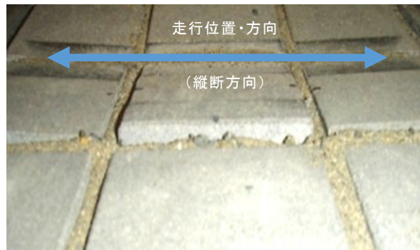
写真-3.3.7 走行試験後の供試体 (Type S-S)
