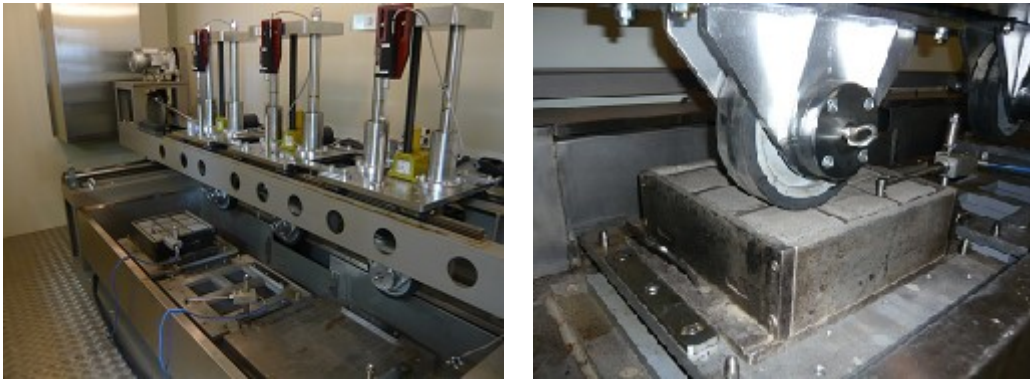
写真-3.3.5 ホイールトラッキング試験状況
