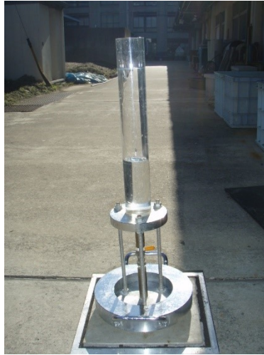
写真-3.3.9 現場透水試験状況
