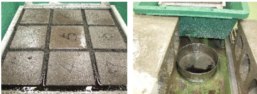
写真-4.3.7 散水後の供試体と流失状況
