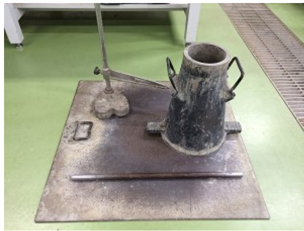
写真-4.3.2 スランプ試験器
