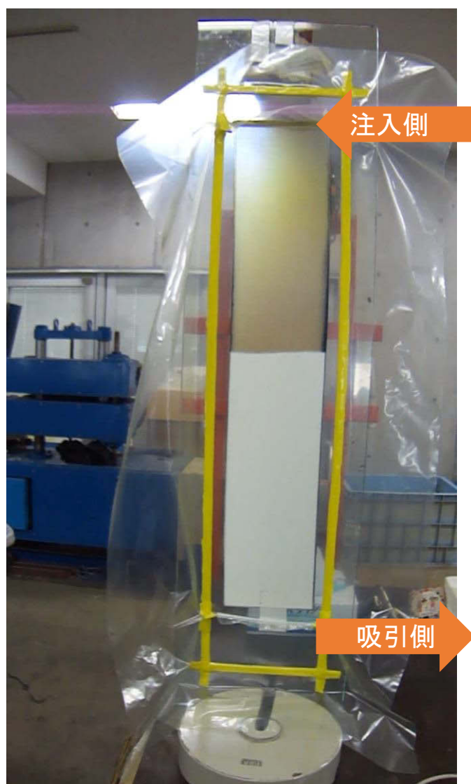
図 3.6 平面板の成形実験（樹脂注入口を上から行った成形：傾斜角度 90^\circ ）
