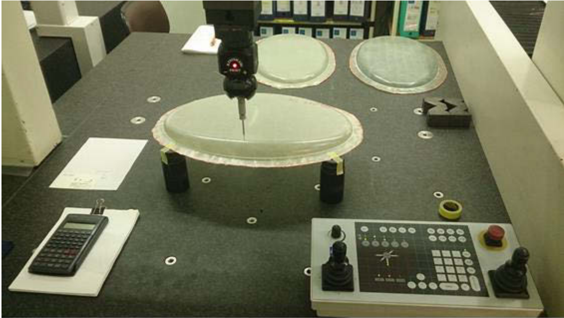
図 4.7 楕円ドーム形状の成形品の計測
