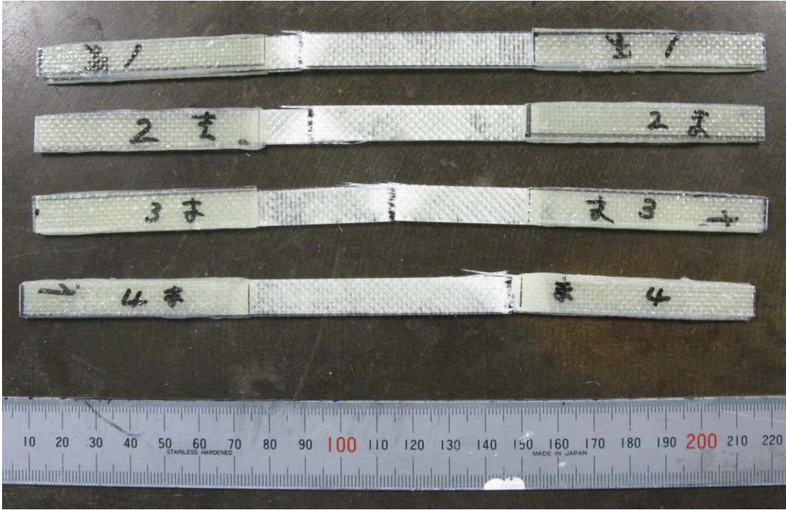
図 3.13 引張試験片の破断状態（横糸方向フローメディアなし傾斜角度 0^\circ ）
