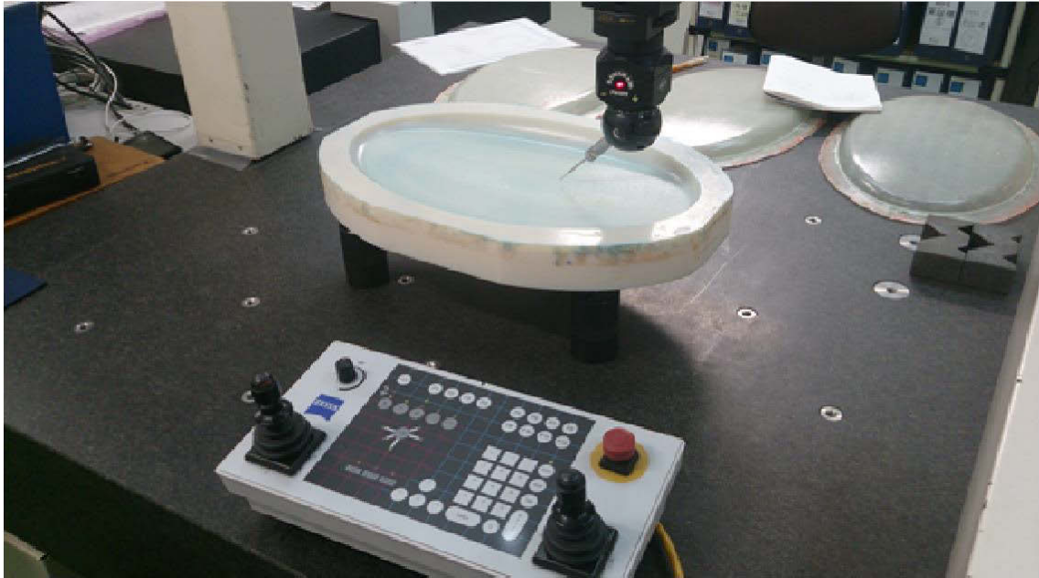
図 2.12 楕円ドーム型の 3 次元測定器での計測
