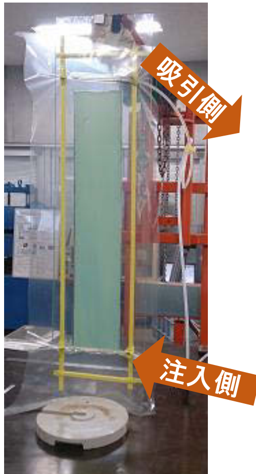
図 3.5 平板の成形実験（傾斜角度： 90^\circ ）
