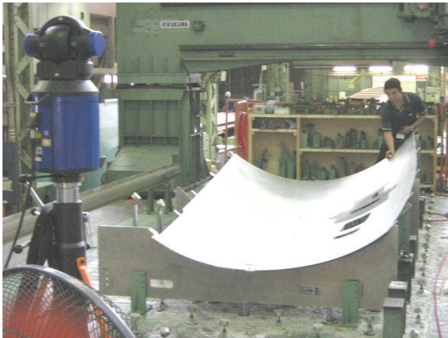
図 6.7 スキン部品三次元形状計測方法
