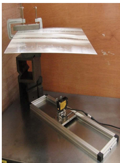
図 4.2 自重変形実験セットアップ
