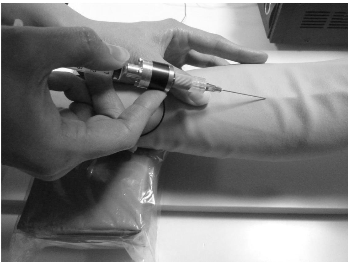
図 3 - 2. 穿刺力波形測定の様子
