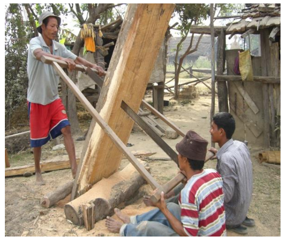
写真3 家の建築用木材の切断
