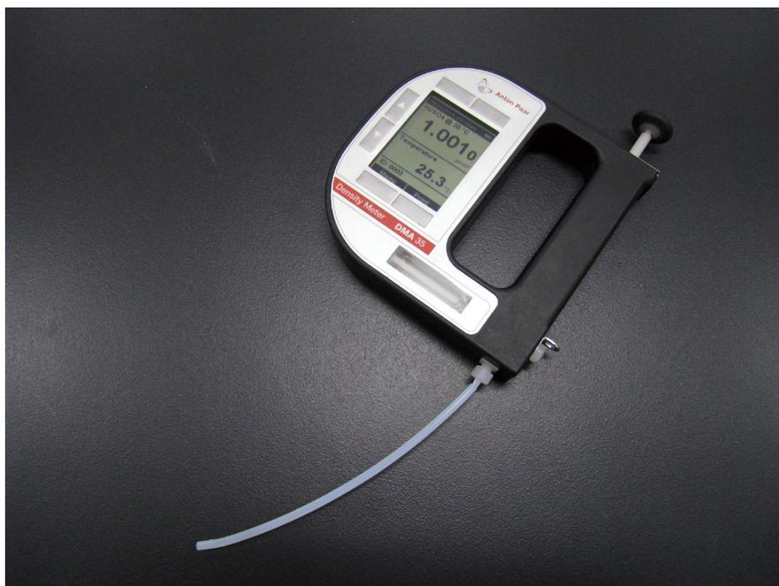
写真-4.1 振動式密度計（アントンパール DMA 35）
