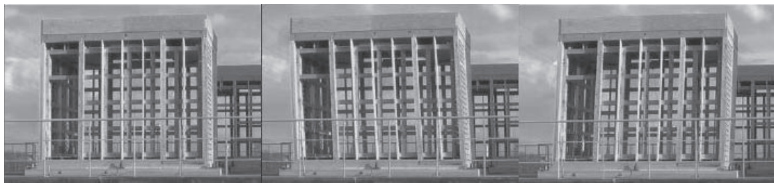
a) 載荷前 b) 左側変形時 c) 右側変形時
