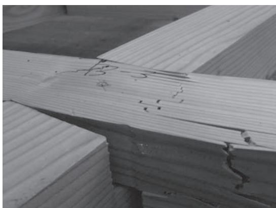
a) L90_E0N 曲げ破壊
