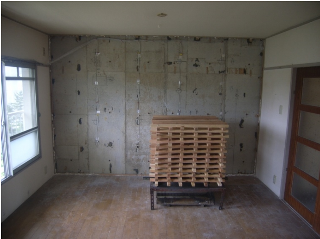
(a) コンクリート壁面と火源用クリブ
