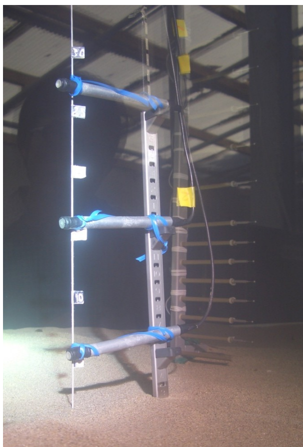
図-3.4 風洞内の圧電飛砂計の設置状況
