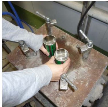
図 3-2 振動締固め状況
