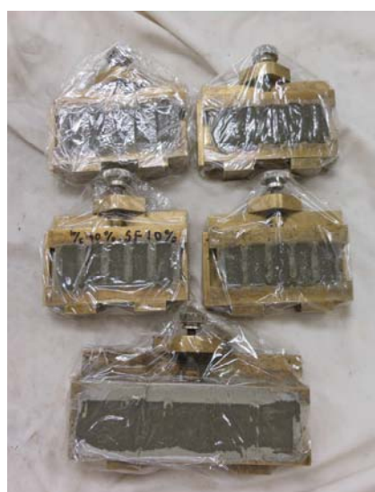
図 5-5 モルタル打設後
