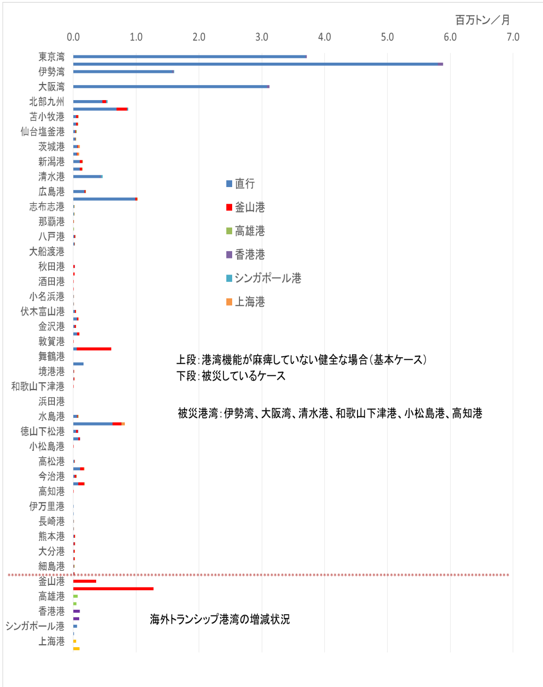
図 11 ケース 3 : 東海・東南海、南海地震により静岡県～高知県の港湾機能が麻痺
