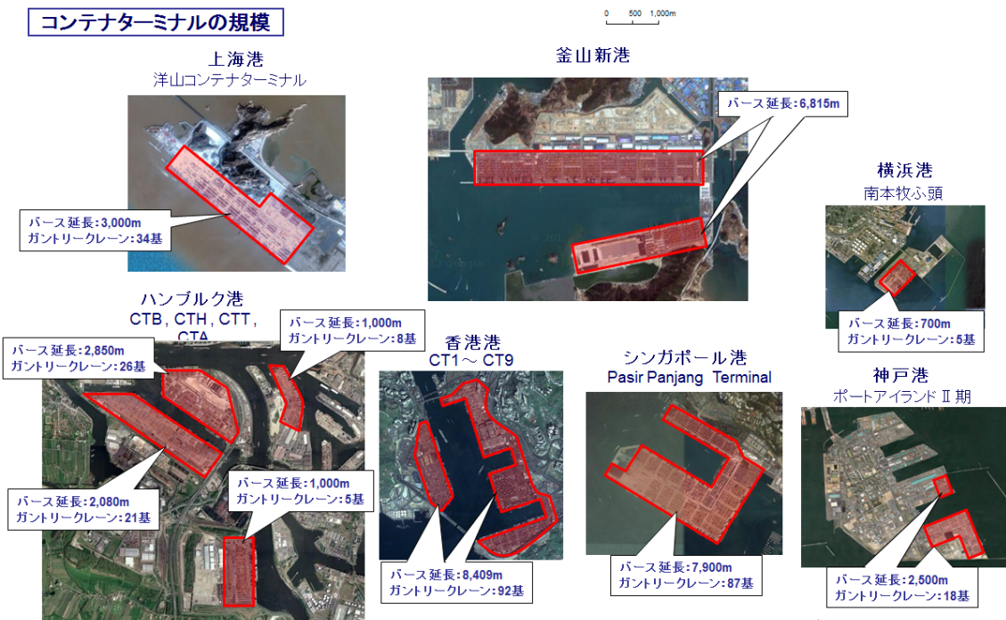
図 40 世界のコンテナターミナルの規模の比較 (同縮尺) (出典) 2011年版国際輸送ハンドブック、各港公表計画等をもとに国土交通省港湾局が作成した資料
