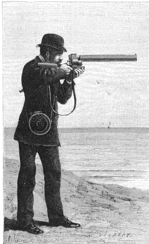
図 1.3.1 『ラ・ナチュール』誌に掲載された写真銃の図 74
